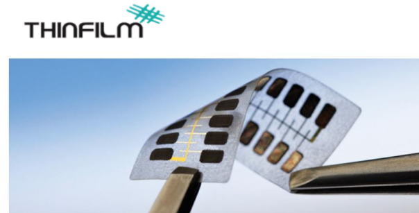
強誘電ポリマーを用いたPlastic memory
